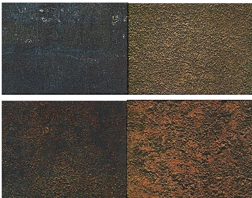
Рисунок 2. Внешний вид образцов стали 45 с напыленным покрытием из стали 30XГСА (а, б) и без него (в, г): а, в – 2 суток выдержки в климатической камере; б, г – 8 суток выдержки в климатической камере
