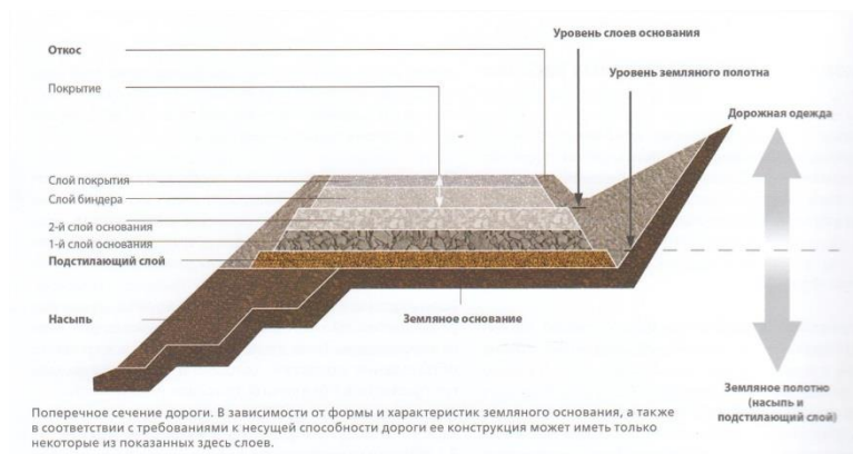
Рисунок 1. Поперечное сечение автомобильной дороги.
