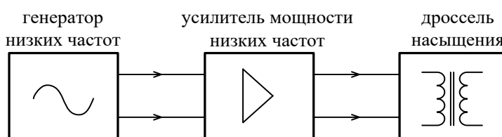
Рисунок 3. Функциональная схема исследования энергетических характеристик ДН.
