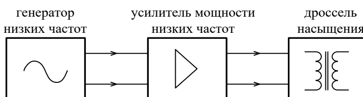
Рисунок 3. Функциональная схема исследования энергетических характеристик ДН.
