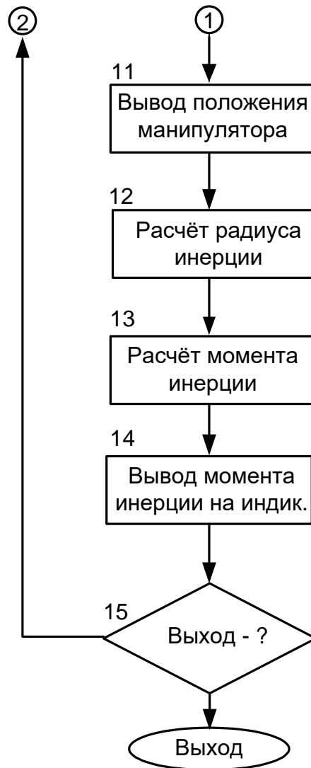
Рисунок 5. Блок-схема алгоритма работы модели момента инерции манипулятора (продолжение)
