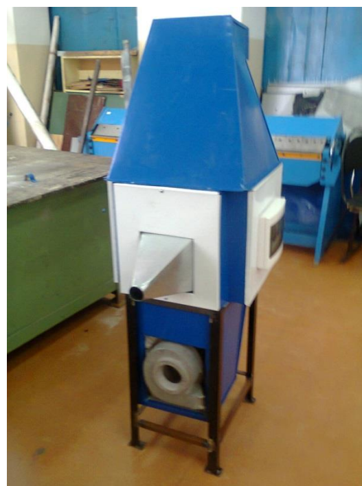
Рисунок 2. Схема и общий вид двухконтурного теплогенератора для РСЛО.
