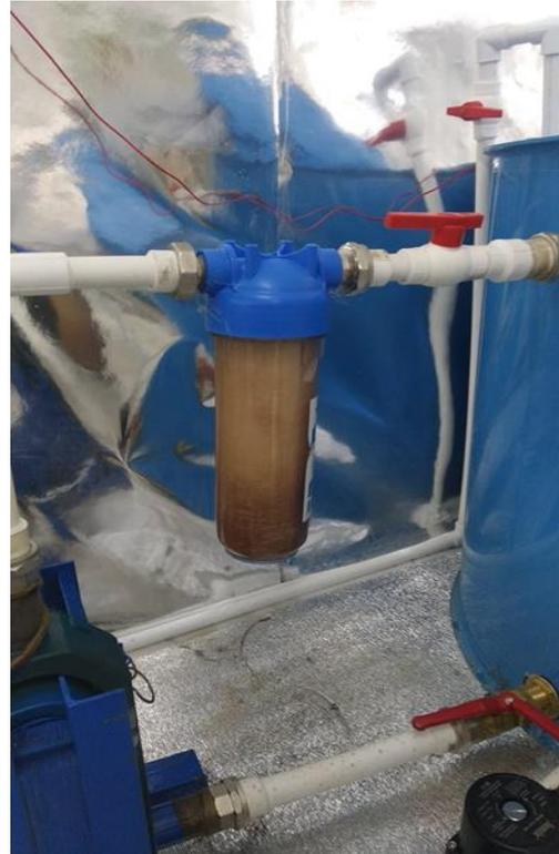
Рисунок 9. Индуктивно-кондуктивный нагреватель мощностью 1 кВт, с напряжением 220 В.
