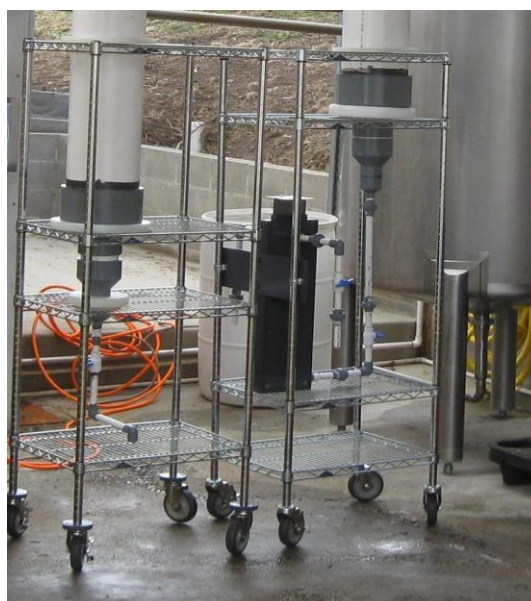
Рисунок 2, - на рисунке показан мобильный вариант как пример адаптации мобильной надсистемы электрохимического реактора в экосистеме реставрированного производственного помещения завода по производству молочных продуктов, требования к экологической чистоте всех процессов технологического передела которого самые высокие.
