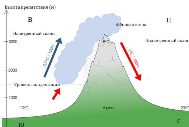
Рисунок 1. Схема фёнового эффекта. Автор: Slbch.
