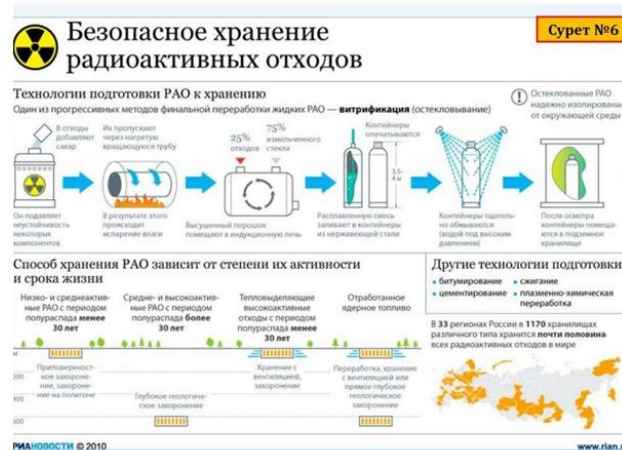
Рисунок 2. Безопасное хранение радиоактивных отходов: схема процесса.
