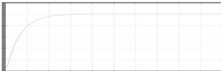
Рисунок 9. График переходного процесса изменения высоты h на заданную величину высоты подъема корпуса до 0.32 метров.
