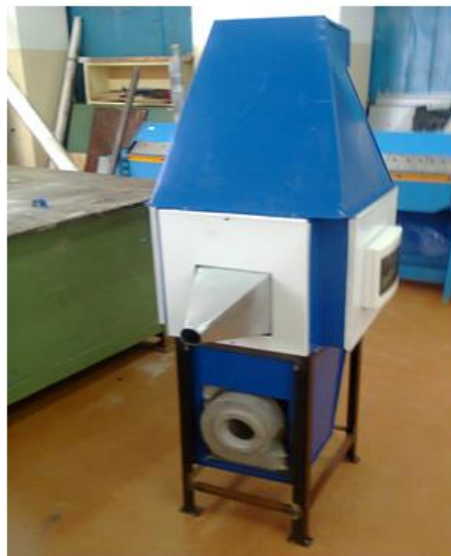
Рисунок 2. Схема и общий вид двухконтурного теплогенератора для РСЛО.
