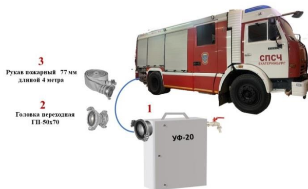
Рисунок 3. Принцип подключения устройства фильтрации: 1 – устройство фильтрации (УФ-20); 2 – головка переходная ГП 50х70; 3 – рукав пожарный 77 мм длиной 4 метра.
