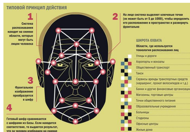
Рисунок 1. Система FindFace SDK для распознавания лиц: идентификация лица на видео или фото, построение биометрического шаблона и сравнение его с другими шаблонами в базе данных[2].
