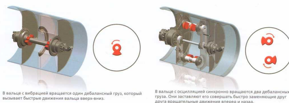
Рисунок 1. Работа вальцов с вибрацией и осцилляцией.
