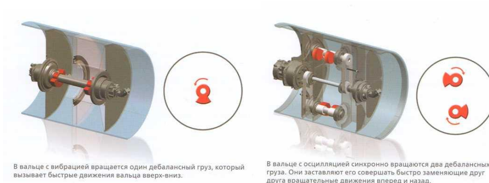
Рисунок 1. Работа вальцов с вибрацией и осцилляцией.
