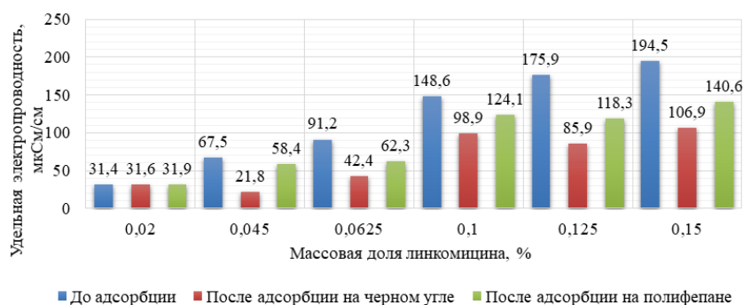
Рисунок 1. Изменение электропроводности растворов линкомицина после адсорбции.
