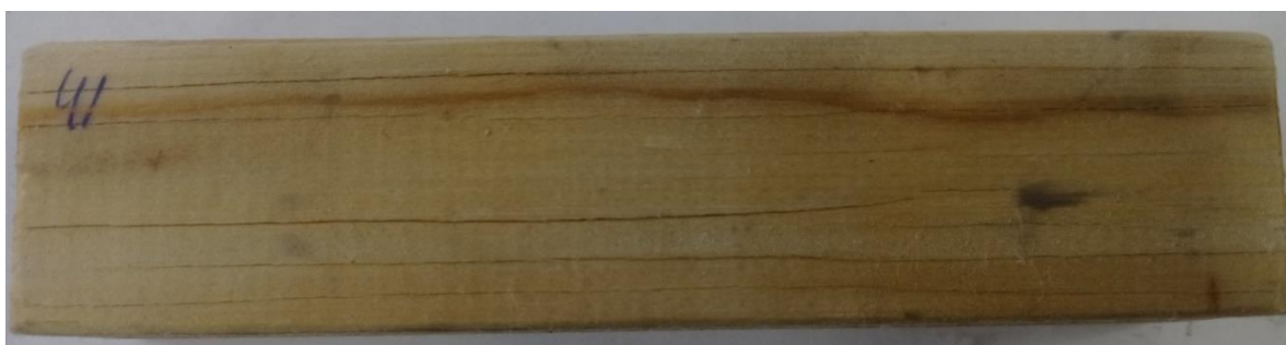
Рисунок 4. Трещины после 2-го цикла замачивания.
