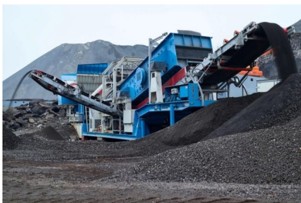
Рисунок 1. Асфальтогранулятор Benninghoven MBRG 2000.
