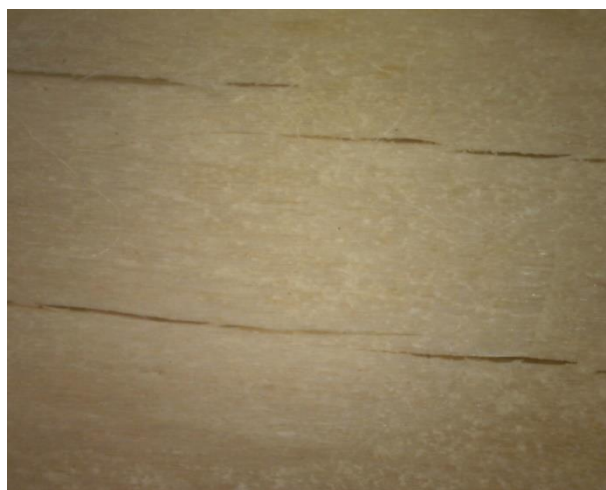
Рисунок 3. Трещины после 1-го цикла замачивания.
