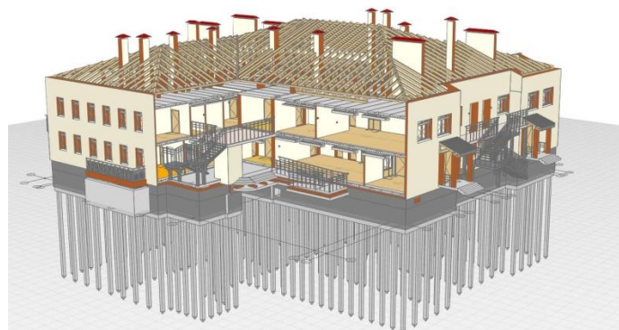
Рисунок 3. Конструктивная модель здания детского сада в Software Renga.
