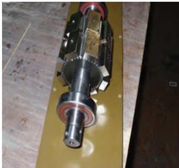
Рисунок 1. Восьмигранный ротор с постоянным магнитом.
