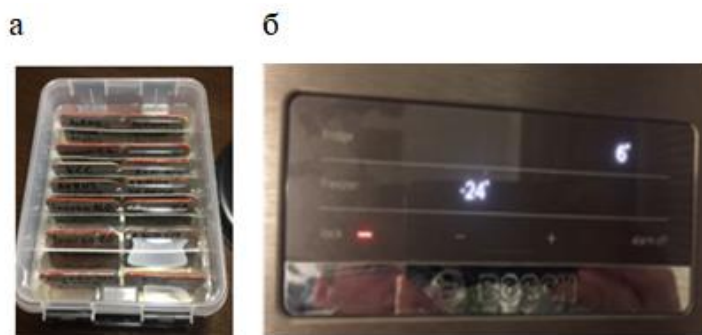
Рисунок 1. Проверка влияния отрицательных температур на ЛКП: а) емкость с образцами, погруженными в воду; б) дисплея температуры внутри холодильной камеры Bosh.
