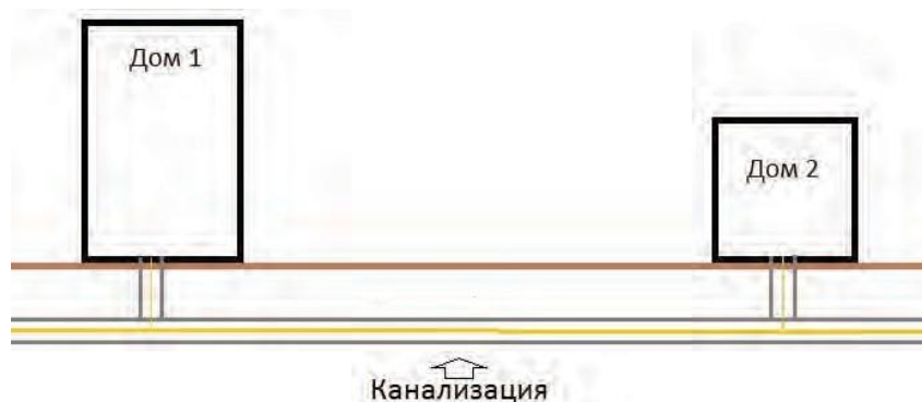
Рисунок 3. Прокладка волокон через канализацию.
