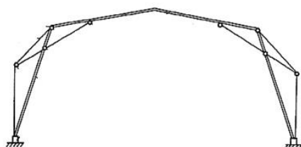
Рисунок 1. Металлическая рама каркаса здания.
