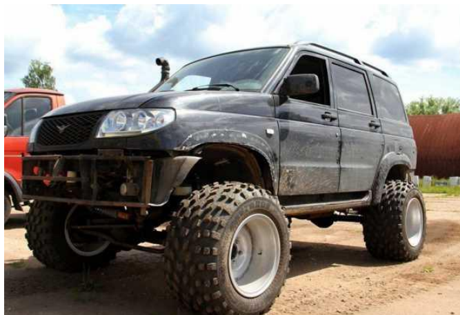
Рисунок 2. Применение шин низкого давления на УАЗ Патриот.
