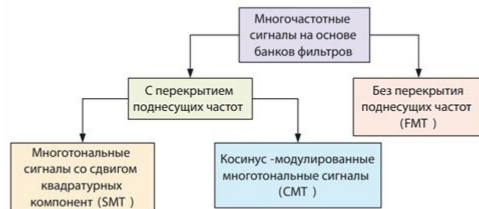
Рисунок 1. Сигнал, построенный с использованием блока фильтров.
