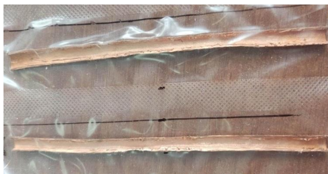
Рисунок 6. Штенгельная трубка без дефектов в разрез.
