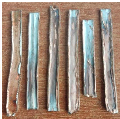
Рисунок 5. Штенгельные трубки с наличием «паразитных» слоев в разрезе.
