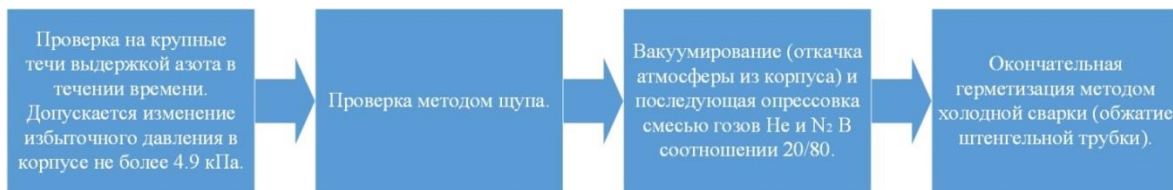
Рисунок 1. Блок схема с последовательностью выполнения основных технологических операций: выдержка под избыточным давлением; проверка на течи методом шупа; опрессовка смесью газов.
