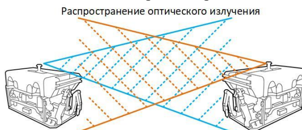
Рисунок 3. Конфигурация рассеянной прямой видимости (diffused LOS)
