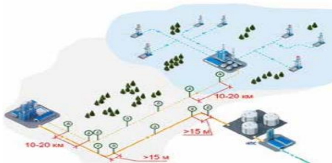
Рисунок 1. Схема расположения датчиков СОУ на трубопроводах
