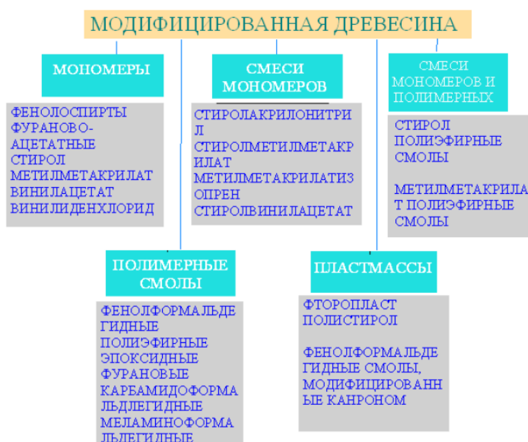
Рис. 1. Структурная схема классификации химических соединений, применяемых для модифицирования древесины
