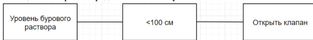
Рисунок 1. Структурная схема открытия отсечных клапанов в емкости очистки бурового раствора
