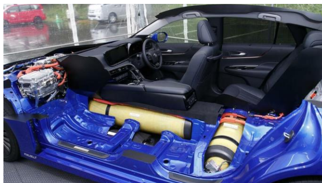
Рисунок 3. Расположение баллонов с водородом в автомобиле Toyota Mirai
