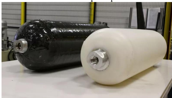
Рисунок 2. Пример водородных баллонов, изготовленных из композитных материалов
