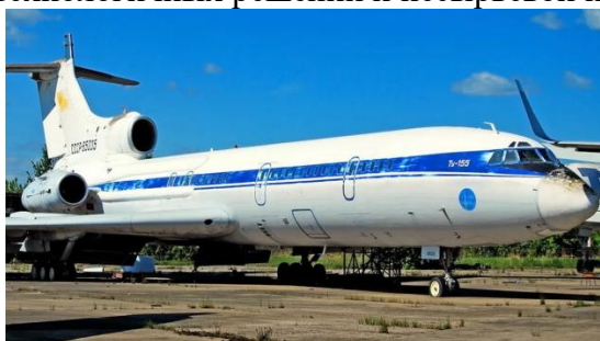
Рисунок 1. Ту-155. Самолет на криогенном топливе.
