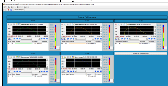
Рисунок 5 – Тренды датчиков расхода.
