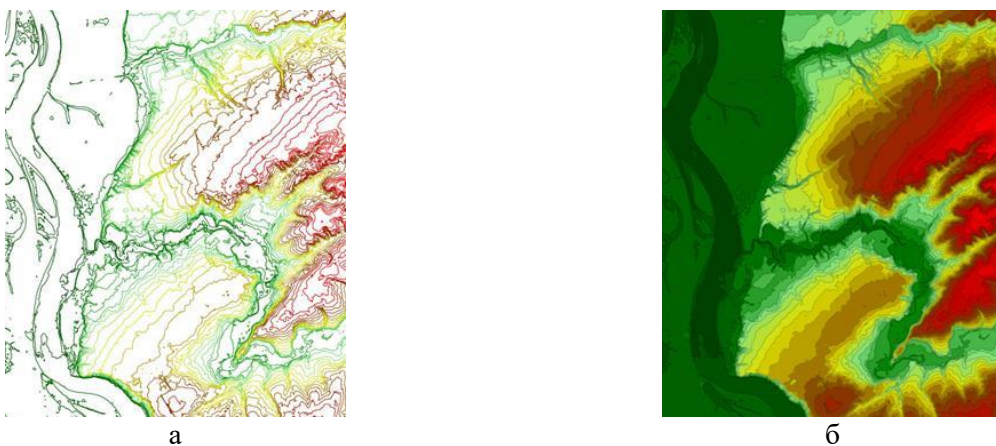
Рисунок 4. Отображение модели рельефа изолиниями (а) и изоконтуррами (б)
