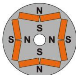
Рисунок 2. Ротор синхронного двигателя с внутренними постоянными магнитами.
