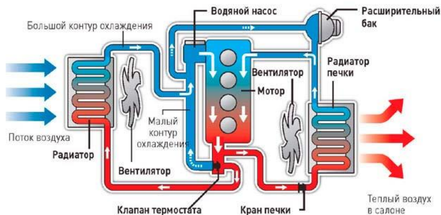
Рисунок 1. Система охлаждения двигателя внутреннего сгорания.
