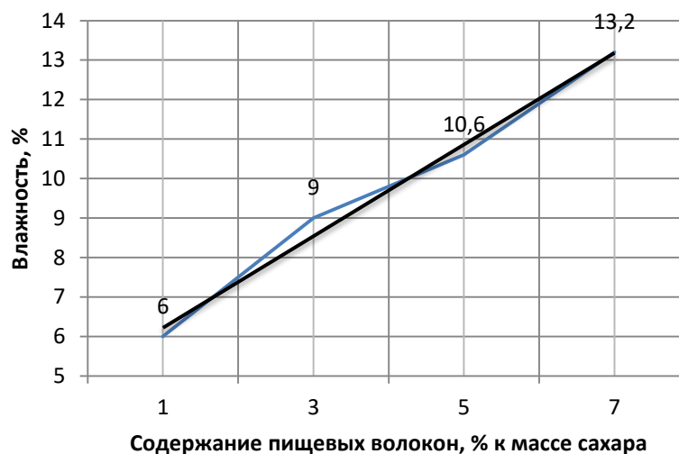
Рисунок 2 – Зависимость влажности помадных конфет, % от содержания свекловичных волокон, % к массе сахара, на 7 сутки после изготовления образцов
