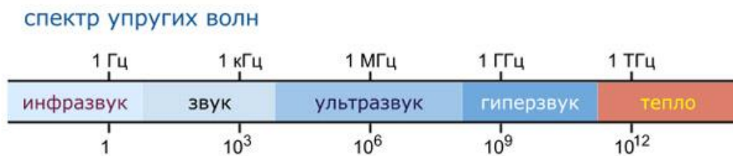
Рис. 1. Схема спектра частот упругих колебаний вещества от инфразвуковых значений, не воспринимаемых человеком, до сверхвысокочастотных, уже тепловых, колебаний. Изображение из обсуждаемой работы [3].
