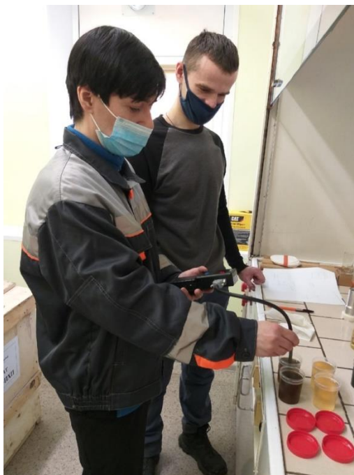
Рисунок 4 – Измерения с использованием индикатора загрязнения жидкости «ИЗЖ-М»
