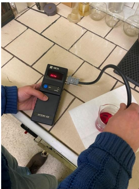
Рисунок 3 – Измерение степени чистоты трансмиссионного масла
