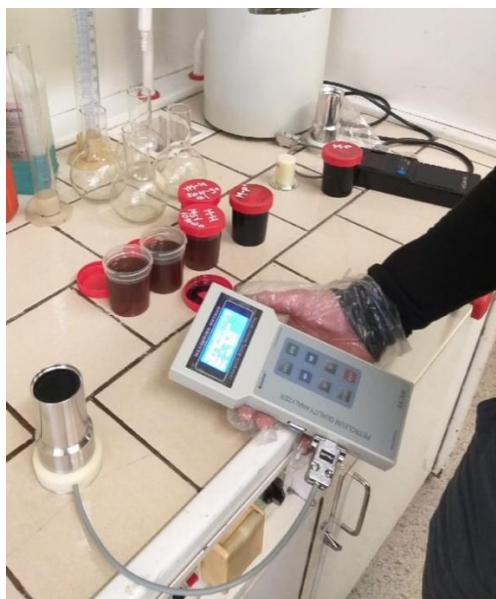
Рисунок 3 – Измерения с использованием «Shatox SX-300» с функцией влагомера
