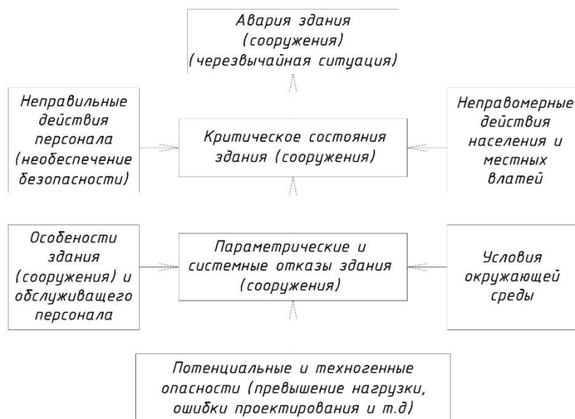
Рисунок 3 – Блок-схема влияния надежности на обрушение здания
