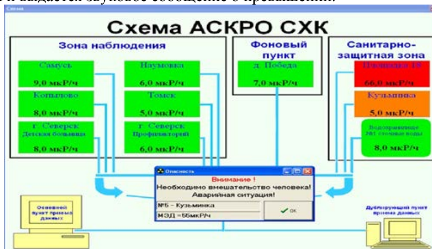
Рисунок 1 - Пример визуального представления на экране монитора компьютера данных контроля при превышении «допустимого» и «аварийного» уровней мощности дозы гамма-излучения.
