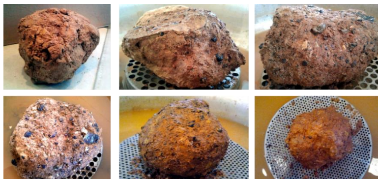
Рисунок 2. Процесс отделения внешнего слоя от ядра окатыша.
