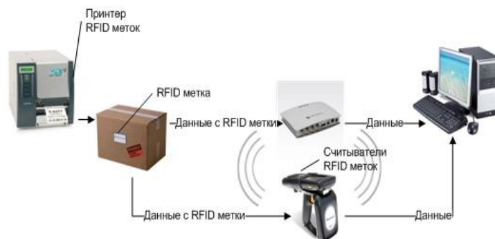
Рисунок 3. Структура системы радиочастотной идентификации передвижения объектов (система RFID) [15].
