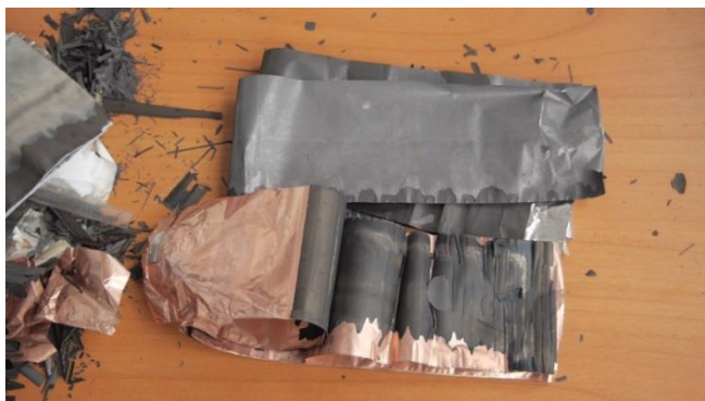
Рисунок 4. Вскрытый литиевый аккумулятор [1].
