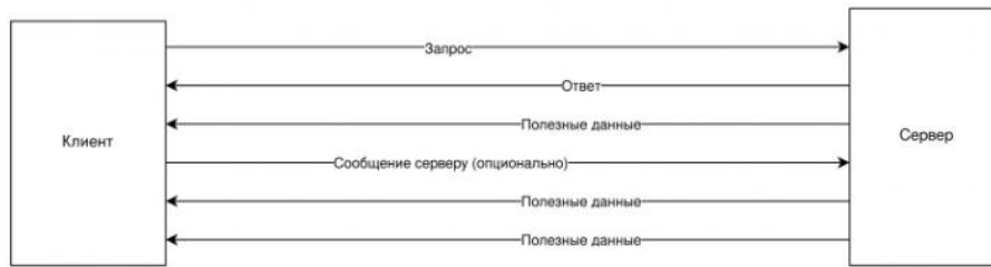
Рисунок 4. Демонстрация работы WebSocket соединения.
