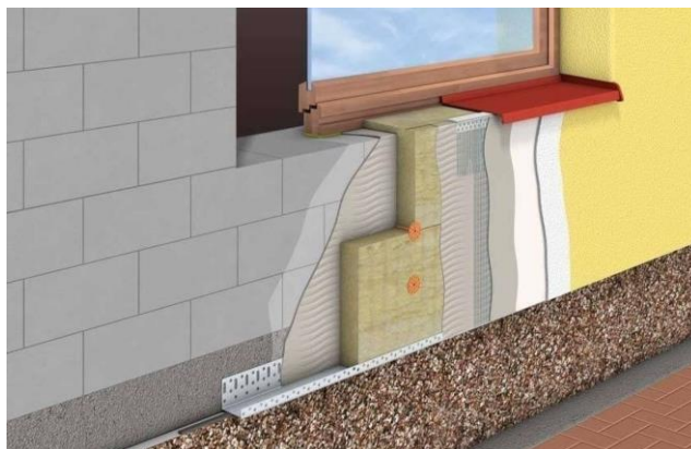
Рисунок 2. Расположение теплоизолирующего слоя в стеновой конструкции.
