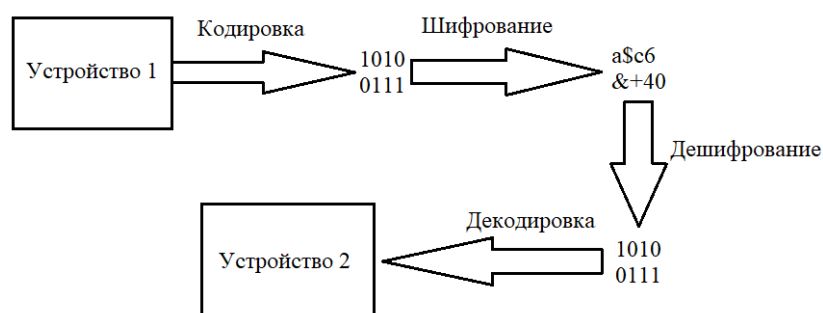
Рисунок 5. Процесс отправки данных между устройствами
