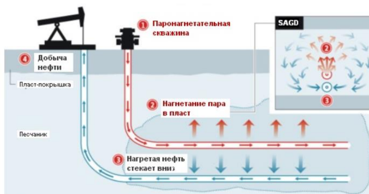
Рисунок 1. Технология добычи методом SAGD.
