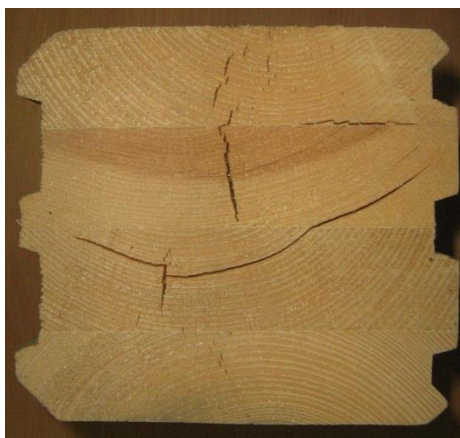
Рисунок 2. ККД с внутренними невидимыми дефектами.
