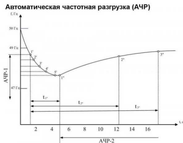
Рисунок 1 Срабатывание очередей АЧР при значительных нагрузках (дефиците активной мощности), повлекший за собой снижение частоты.
