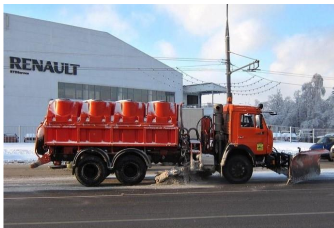
Рисунок 2. процесс обработки покрытия проезжей части химическими противогололедными материалами
