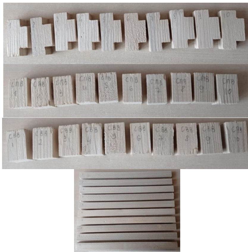
Рисунок 2. Стандартные образцы, предназначенные для механических испытаний На рисунке 3 представлены графические результаты испытаний.
