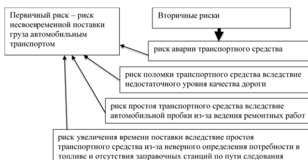
Рисунок 2. Дерево потенциально возможных вторичных рисков при осуществлении поставки груза по конкретному маршруту.
