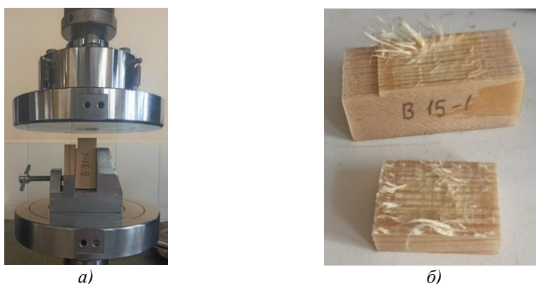
Рисунок 3. Испытание образцов на скалывание при определении водостойкости: а) – установка образца в Instron 5969, б) – характер разрушения.
