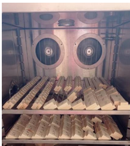
Рисунок 2. Кондиционирование образцов в испытательной камере «Тепло – Холод – Влага» серии КТХВ-300:
