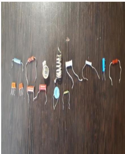
Рисунок 1. Детали, подобранные под 1-ую схему FM-передатчика
