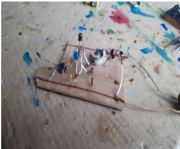
Рисунок 4. Собранная спайка FM-передатчика
