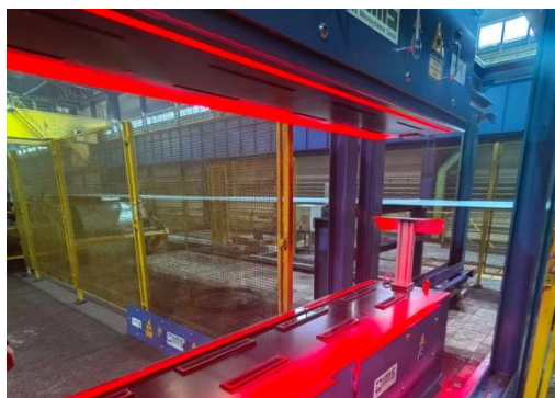
Рисунок 1. Система автоматического контроля качества поверхности холоднокатаного листа.
