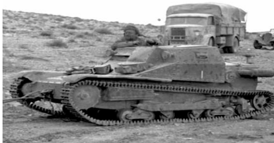
Рисунок 4. Первый итальянский легкий огнеметный танк L3-35/Lf [9].
