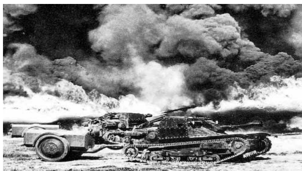
Рисунок 3. Огнеметательная версия танкетки «Ансальдо» [7].
