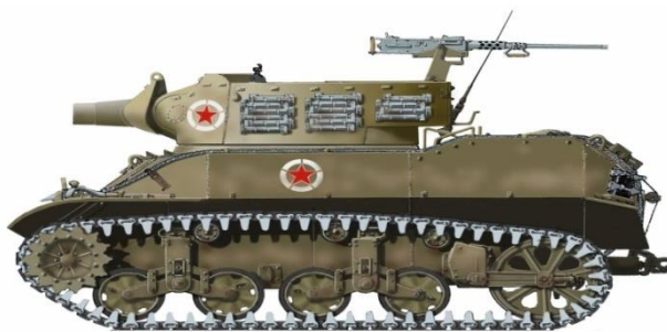
Рисунок 9. Огнеметный вариант танка «General Stuart» [23].
