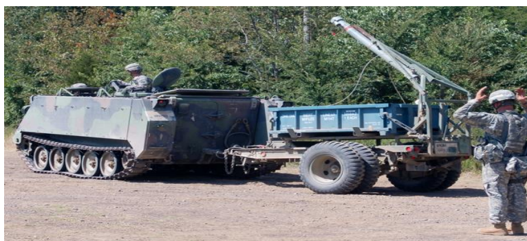
Рисунок 9. Американская установка M58 MICLIC [23].
