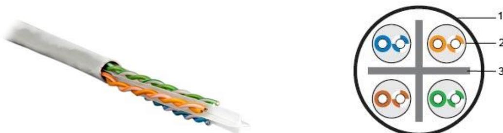
Рисунок 1. Кабель «витая пара» UUTP4-C6-S23-IN-LSZH.
