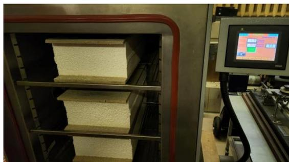
Рисунок 3. Камера тепла холода влажности "КТХВ-300".
