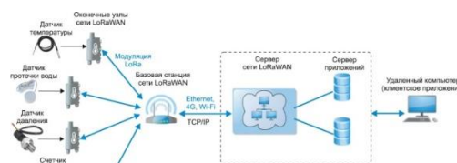
Рисунок 5. Технология LoRaWAN тепловых сетей.
