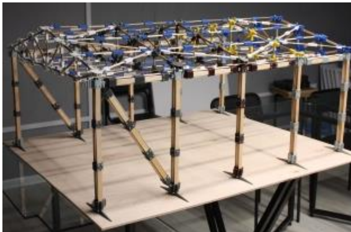
Рисунок 2. Макет каркаса промышленного здания.
