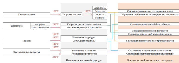
Рисунок 2. Структурные изменения при производстве термодревесиной.
