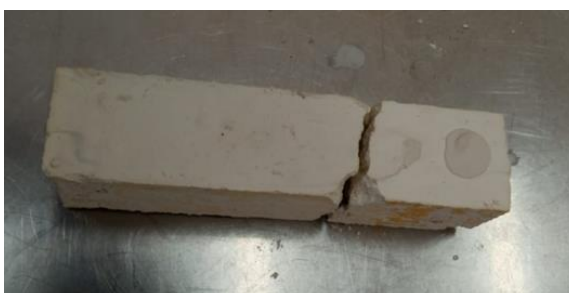
Рисунок 1. Пример гипсового камня из смеси 1/3, поврежденного при извлечении из формы
