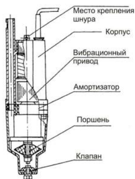
Рисунок 4. Схема вибрационного насоса.
