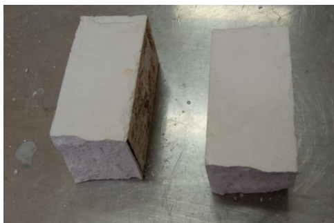
Рисунок 3. Испытанный на изгиб и сжатие образец.
