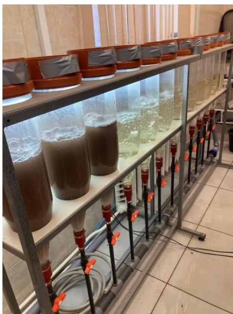
Рисунок 5. «инкубационный аппарат Вейса».
