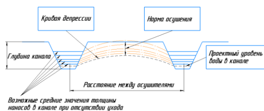
Рисунок 1. Схема расположения осушительных каналов, кривой депрессии, нормы осушения, глубины канала и проектного уровня воды в канале.
