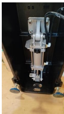
Рисунок 2. Пневмопривод поворотного рычага.
