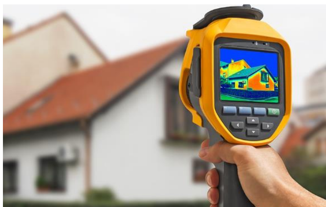
Рисунок 1. Тепловизором для обследования зданий.
