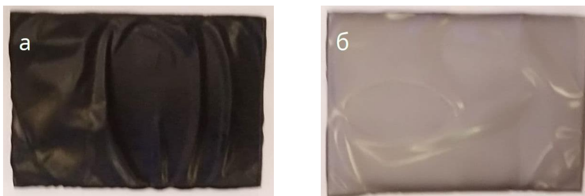
Рисунок 1. Внешний вид пленочных композитов на основе Na-КМЦ, наполненных ТУ в количестве: 10 масс. % (а) и 1 масс. % (б).
