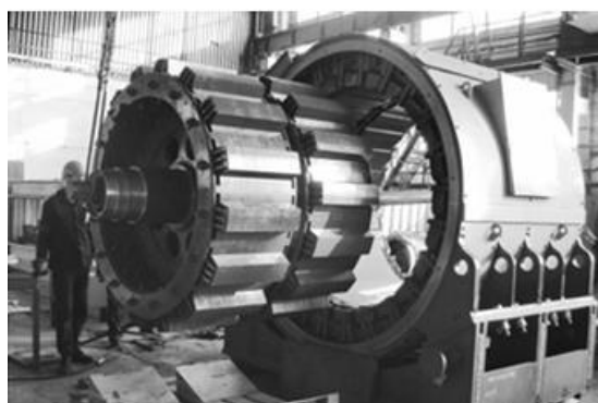
Рисунок 2. Сборка «ИД-2000-200», устанавливаемая на морской буксир-спасатель «Виктор Конецкий».
