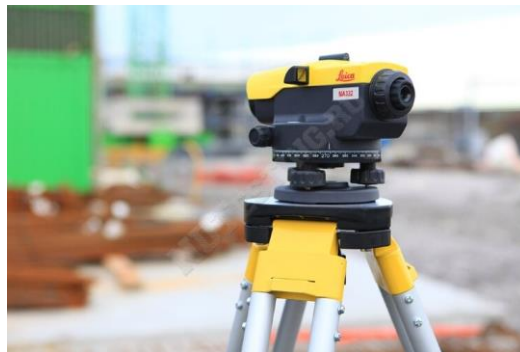
Рисунок 2. Прибор, используемый в геодезических работах – нивелир.
