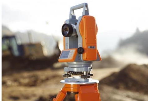
Рисунок 1. Прибор используемый в сельском хозяйстве ,теодолит.
