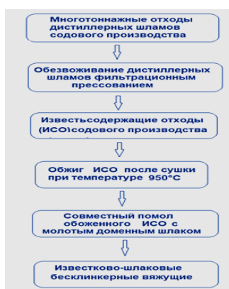
Рисунок 1. Схема получения гидравлических известково-шлаковых вяжущих материалов с использованием крупнотоннажных содовых отходов.
