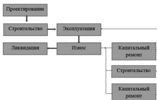
Рисунок 1. Жизненный цикл скважины.
