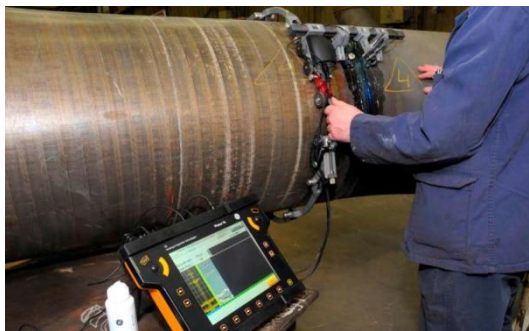
Рисунок 2. Процесс магнитооптической дефектоскопии трубопровода.
