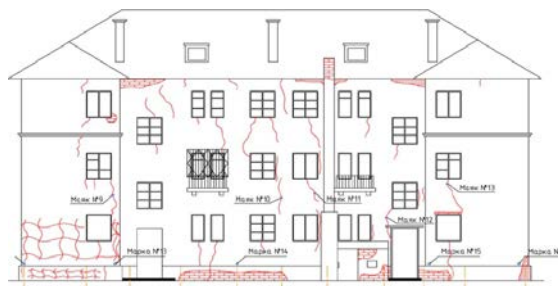
Рисунок 3. Главный фасад пятиэтажного жилого дома с указанием деформационных трещин.
