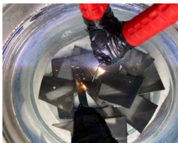
Рисунок 1. Процесс электроэрозионного диспергирования отходов молибдена в изопропиловом спирте.
