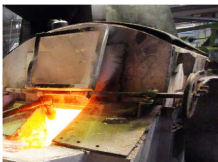
Рисунок 2. Процесс литья алюминия в прессформы [3].
