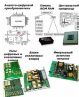
Рисунок 2 – Состав блоков микропроцессорной релейной защиты
