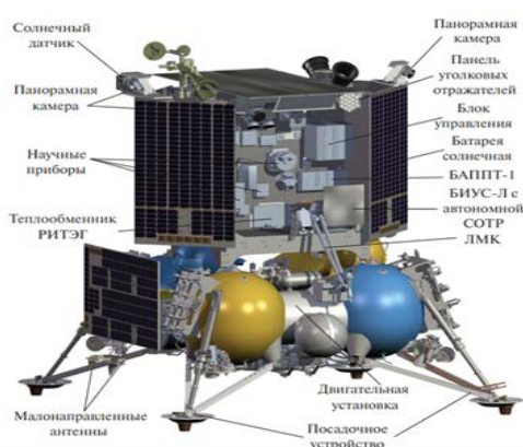
Рисунок 2. Общий вид и основные системы КА «Луна-25».
