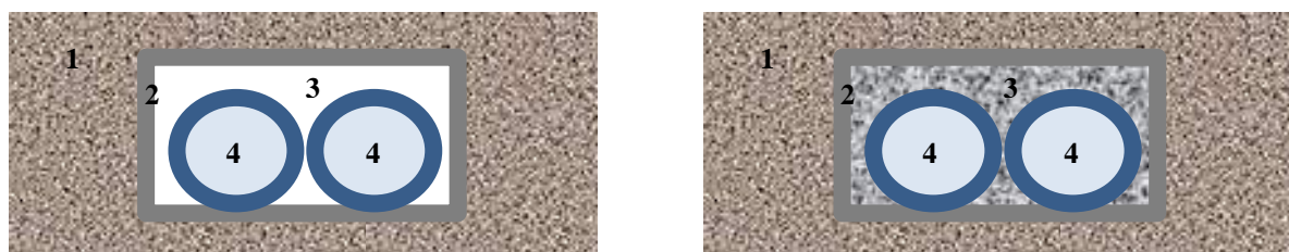
Рисунок 1. Схема засыпки трубопровода вермикулитом (поперечный разрез)
