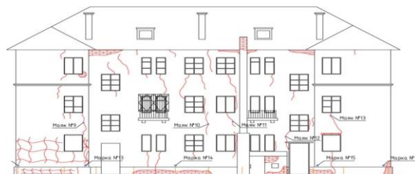
Рисунок 3. Главный фасад пятиэтажного жилого дома с указанием деформационных трещин
